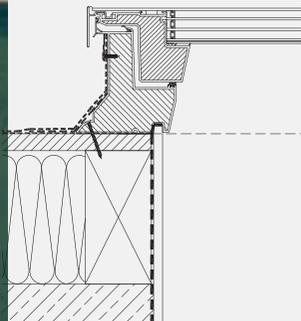
Новые светопрозрачные конструкции FAKRO позволяют обеспечить естественное освещение и проветривание помещений, расположенных в зданиях с плоскими крышами. Окна D\_C, D\_F изготавливаются из многокамерного профиля ПВХ на основе кальций-цинкового стабилизатора без свинца, внутренняя часть профилей заполнена утеплителем. Новое поколение окон для плоских крыш отличается большей полезной площадью остекления и высокими показателями энергосбережения.
