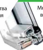
Многокамерный профиль ПВХ белого цвета, который с внутренней стороны укреплен оцинкованными стальными профилями. Материал водонепроницаем и отличается высокой степенью сопротивления к воздействию кислот и спиртосодержащих жидкостей.
