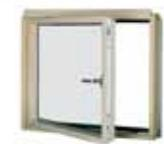
Карнизное окно располагается в верхней части фасада и предназначено для установки в группе со стандартным мансардным окном, которое монтируется непосредственно в крыше. Модель BDR/BDL имеет комбинированную систему открывания (боковое на 90° и откидное до 11 см для проветривания), BVP имеет откидное открывание до 11 см, BXР – глухое.
